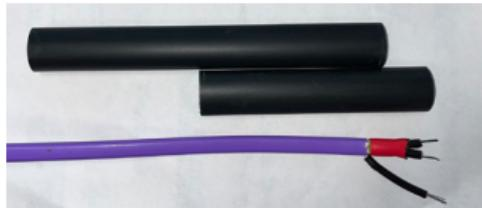
Installer krympeslange 8/2x35 mm over de 3 ledningene på forsyningskabelen, og krimp på ferrulene.
