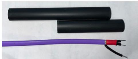
Instalujte smršťovací bužírku 12/3x17 mm přes střední izolaci a zahřejte ji.
