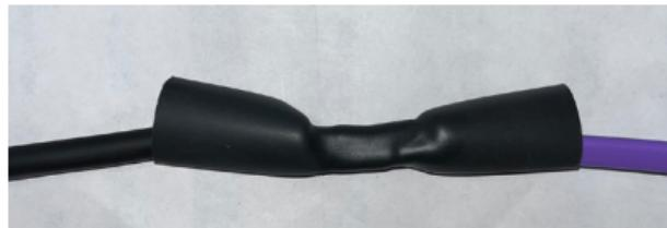
Centrez la gaine thermorétractable 19/6x200 mm sur les connexions et chauffez de l'intérieur vers l'extérieur
