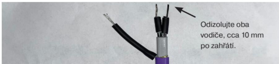
Instalujte smršťovací bužírku 12/3x17 mm přes střední izolaci a zahřejte ji.
