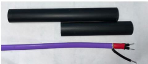
Paigaldage 8/2x35 mm kuumakahanemistoru toitekaabli kolme juhtme peale ja pressige otsahülsid peale
